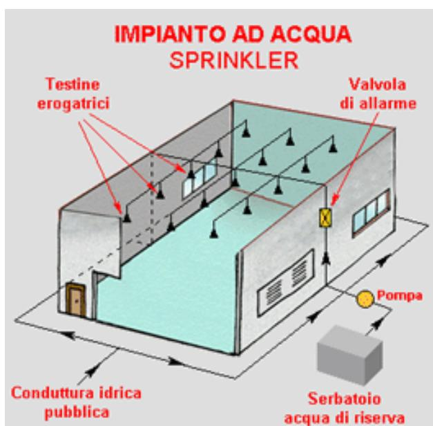
La rete di tubazione interna al locale protetto, ha origine dalla **stazione di controllo**, elemento caratteristico di questa tipologia di impianto, che è installata in un apposito ambiente, che comprende una valvola di controllo e allarme, una valvola di intercettazione e tutte le valvole e gli accessori a corredo, per il controllo dell’impianto sprinkler propriamente detto.
