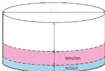
L'altezza dei due livelli acqua/benzina (1/3 acqua – 2/3 benzina) è sempre di 32 mm entro fusto di differente diametro.
