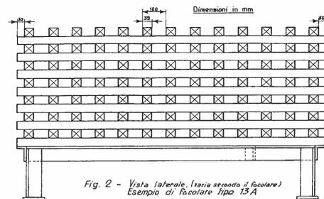
Fig. 2 - Vista laterale. (varia secondo il focolare)
