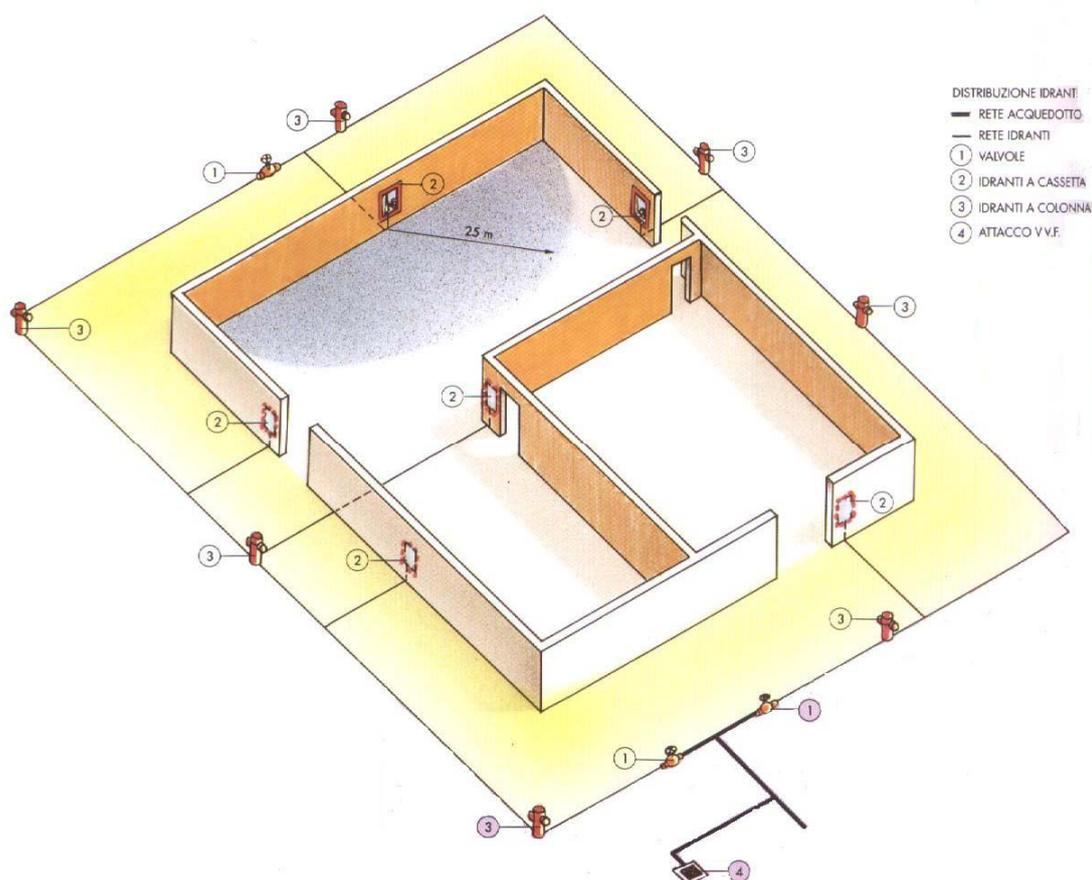
Gli idranti soprasuolo sono dotati di punto prefissato di rottura che permette la separazione della parte superiore dalla parte inferiore dell'idrante a seguito di un urto accidentale, senza causare la fuoriuscita dell'acqua con conseguente riduzione della pressione della rete antincendio e possibilità di allagamenti.
