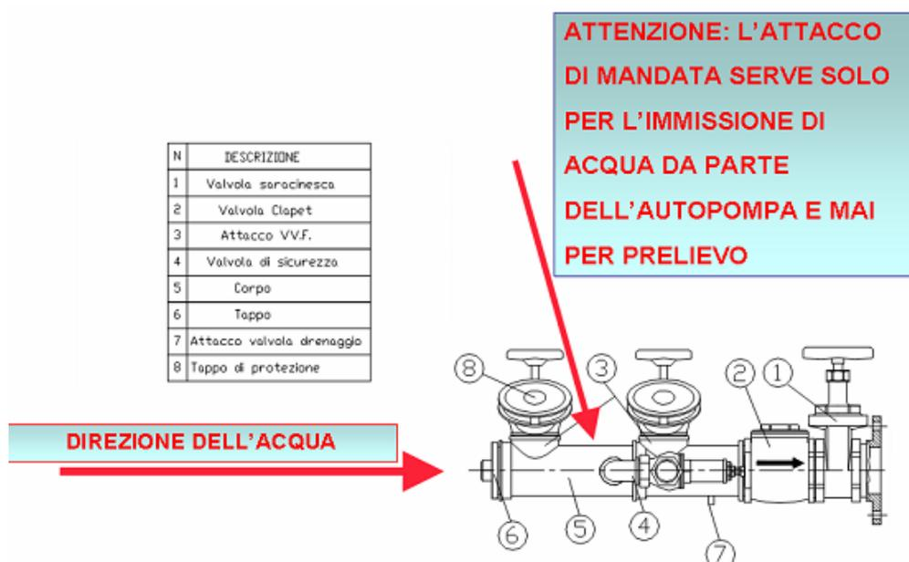
*N.B.: Per verificarne il corretto montaggio, con valvola di intercettazione aperta, verificare che con l'apertura delle valvole di attacco dn 70 fuoriesca l'acqua.*
