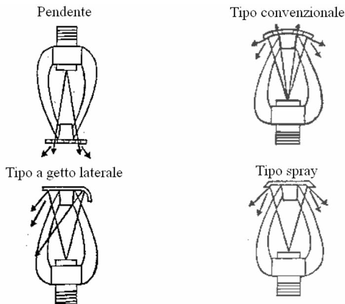
Devono essere utilizzati sprinkler del tipo rivolti verso l'alto (upright) negli impianti a secco, alternativi e a preazione, eccetto quando vengono impiegati sprinkler del tipo a secco pendente (dry pendent).
