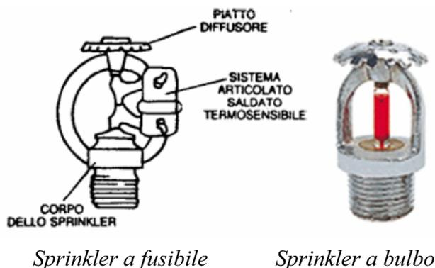
L'erogazione dell'acqua, ovvero l'entrata in funzione dell'impianto, è determinata dalla rottura dell'ampolla o del fusibile di chiusura a seguito del raggiungimento di una determinata temperatura all'interno dell'ambiente.
