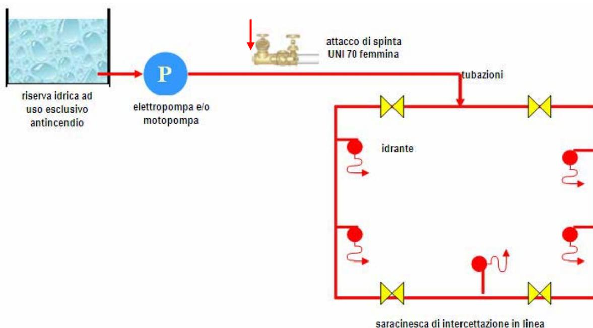
Lungo la rete di tubazioni sono poi installate, in posizione facilmente accessibile e segnalata, le valvole di intercettazione che devono essere bloccate, mediante apposito dispositivo, nella posizione di normale funzionamento.
