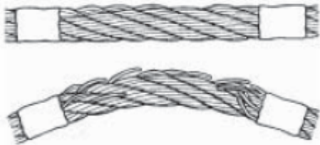
Rotture dei fili nella SEZIONE INTERNA
