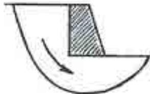
Figura 15.15 - Muro di sostegno: Verifica di stabilità globale
