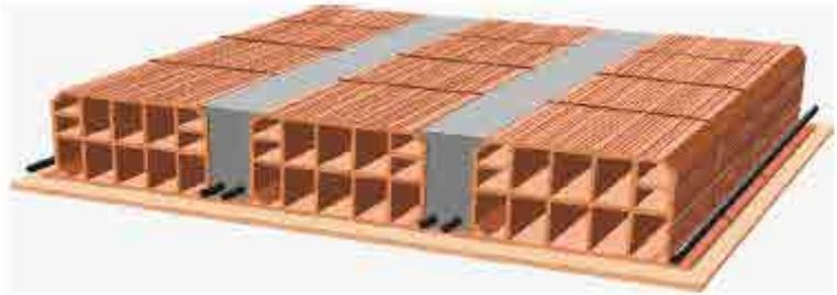
Figura 10.7 – Solaio in laterocemento gettato in opera: assonometria
