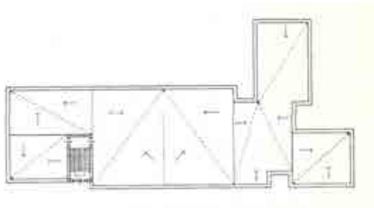
Figura 12.11 - copertura a terrazzo. Convogliamento delle acque meteoriche
