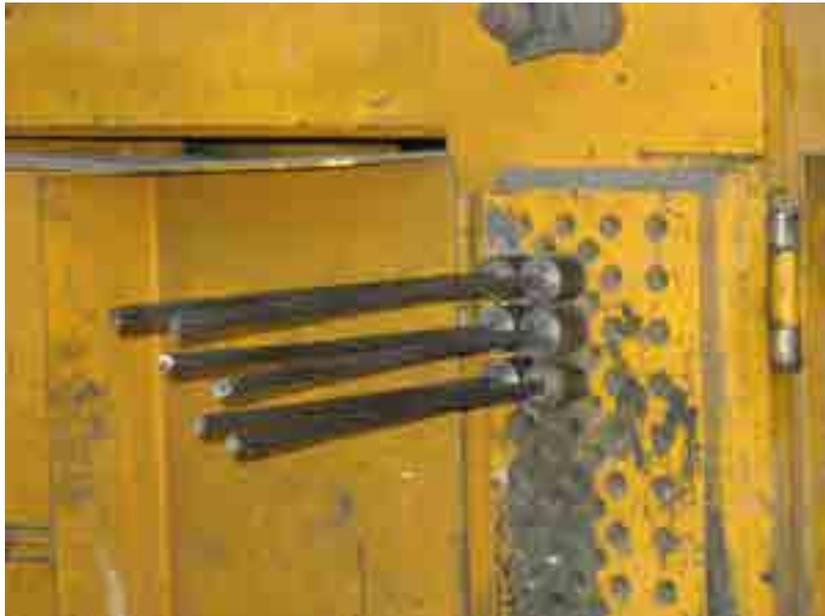
Figura 6.4 - Particolare della testata in una pista di precompressione
