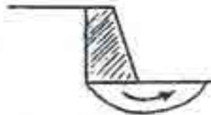
Figura 15.14 - Muro di sostegno: Verifica della capacità portante
